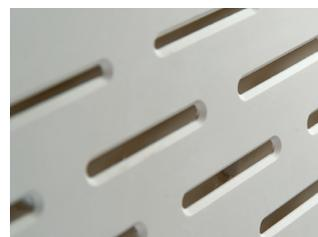
El deflector Opti-Zone disminuye las variaciones típicas de la velocidad del aire de extracción y proporciona un flujo horizontal. El patrón y el tamaño especial de sus ranuras proporcionan uniformidad a la velocidad del flujo de aire aumentando las velocidades en el punto medio y en la superficie de trabajo, donde es necesario, mientras disminuye las velocidades en las esquinas.
