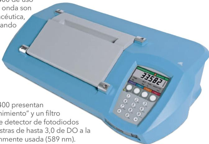
Los polarímetros de la Serie ADP400 presentan una fuente de luz LED "sin mantenimiento" y un filtro de interferencia con tecnología de detector de fotodiodos que proporciona lecturas de muestras de hasta 3,0 de DO a la longitud de onda de sodio comúnmente usada (589 nm).
