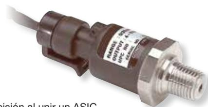
Se obtiene una alta precisión al unir un ASIC de alto rendimiento a un sensor de presión con película fina de polisilicio estable. El sensor está soldado mediante haz de electrones a un accesorio de presión de acero inoxidable, lo que proporciona una alta capacidad de sobrepresión y una sobresaliente durabilidad contra golpes y vibraciones. El conjunto de circuitos del transductor está fijado firmemente al interior de una jaula interna y se alberga en un gabinete de nylon reforzado.
