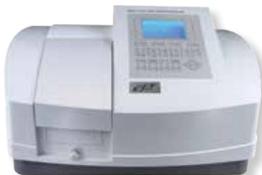
Especifique la configuración paramétrica del método con controles sencillos en el teclado o de la computadora. Visualice los gráficos espectrales en la pantalla LCD con retroiluminación. El compartimento de la muestra es para hasta 8 cubetas con longitudes de trayectoria de hasta 100 mm.
