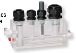
El bloqueo de flujo multisonda se puede usar directamente en línea con los sistemas de bombas para agua de pozo y funciona con caudales de 100 mL/min hasta 1 GPM. El sistema de acrílico para bloqueo de flujo acepta hasta cuatro tipos de sondas, lo que permite medir varios parámetros de una muestra al mismo tiempo.
