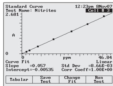
La pantalla Standard Curve permite configurar fácilmente métodos de concentración. Puede seleccionar hasta 5 ajustes de curva distintos, 15 valores estándar y 10 unidades de medición prefijadas, o bien crear sus propias curvas.
