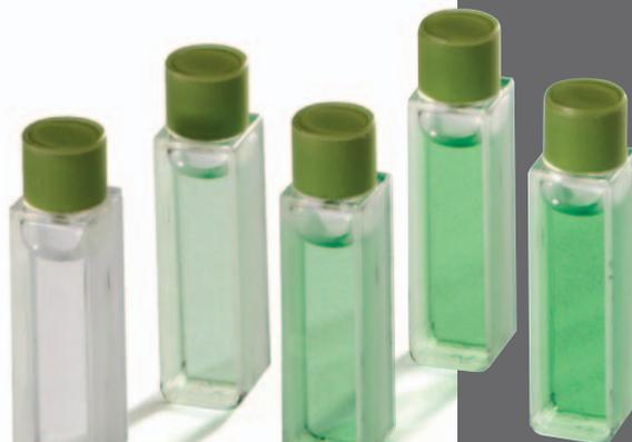
Los instrumentos de la serie GENESYS 10S pueden disponer también de un económico colorante verde estándar para verificar las exactitudes fotométrica y de longitud de onda del instrumento. Con valores certificados a 260, 430 y 630 nm, este estándar permite comprobar la exactitud fotométrica y de longitud de onda desde la zona del ultravioleta hasta el IR cercano.
