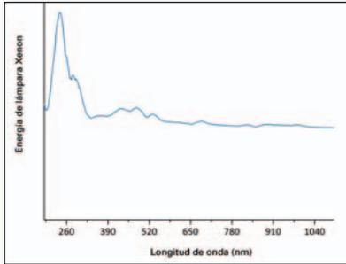
aunque la lámpara de xenón suele conservar su eficacia entre 5 y 7 años sin necesidad de ninguna intervención técnica. Puede incluso que no sea necesario sustituir la lámpara en toda la vida útil del instrumento, ya que solo está encendida durante la toma de medidas. Ventajas de la lámpara de xenón:
